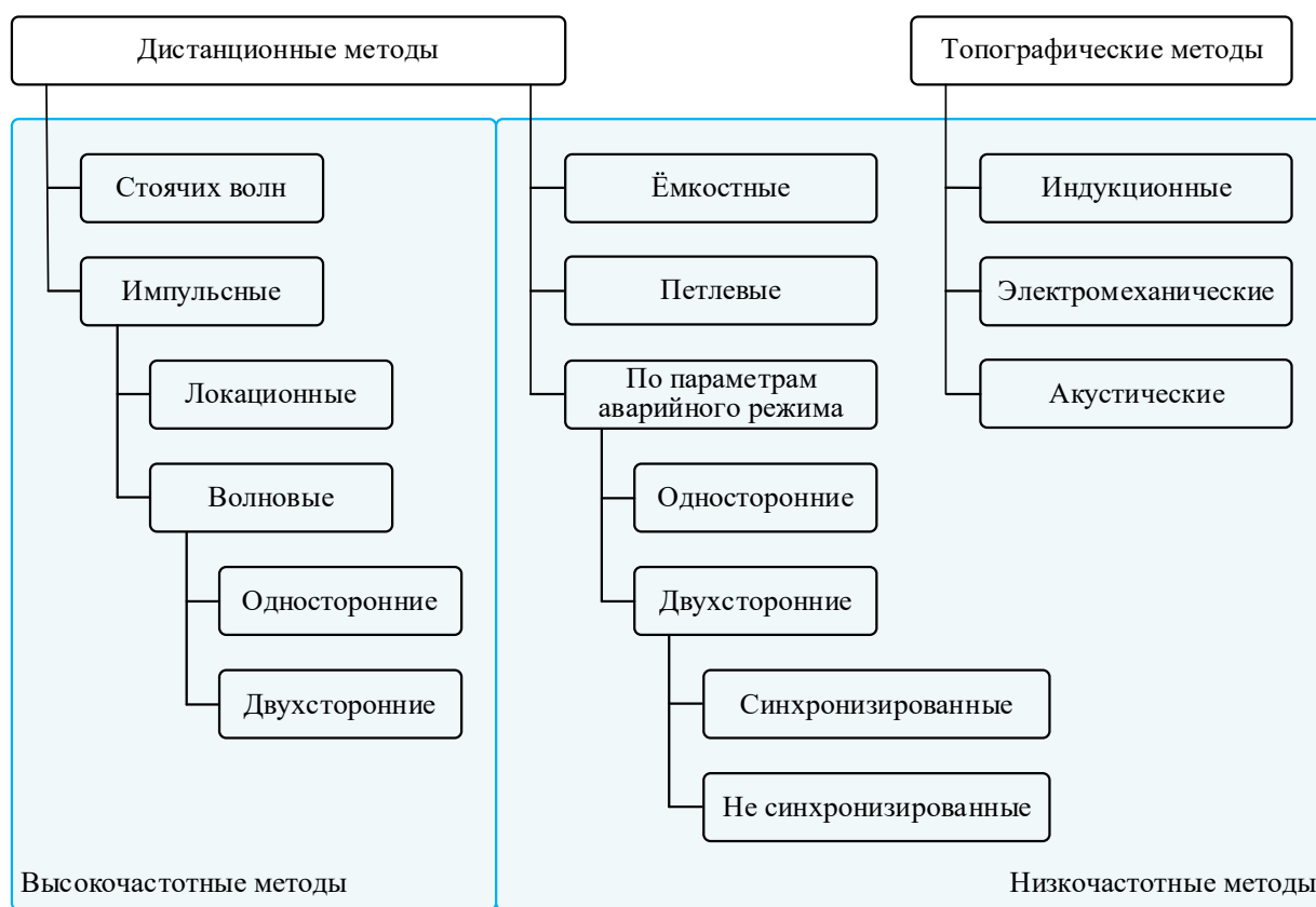
Рисунок 1.13 – Классификация методов определения места повреждения воздушной линии электропередачи
